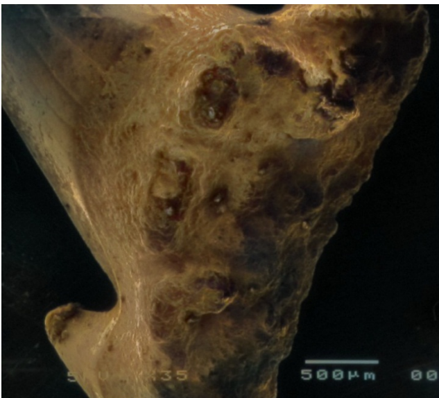
Рис. 5. Общий вид зуба при увеличении 35х (а – исходная микрофотография; б – её колоризация с использованием средств искусственного интеллекта), масштабная линейка/ скейлбар – 500 мкм. Ускоряющее напряжение – 5 кВ
