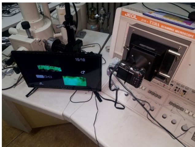
Рис. 3б. Система с внешним телемонитором в процессе фотографирования с экрана СЭМ
