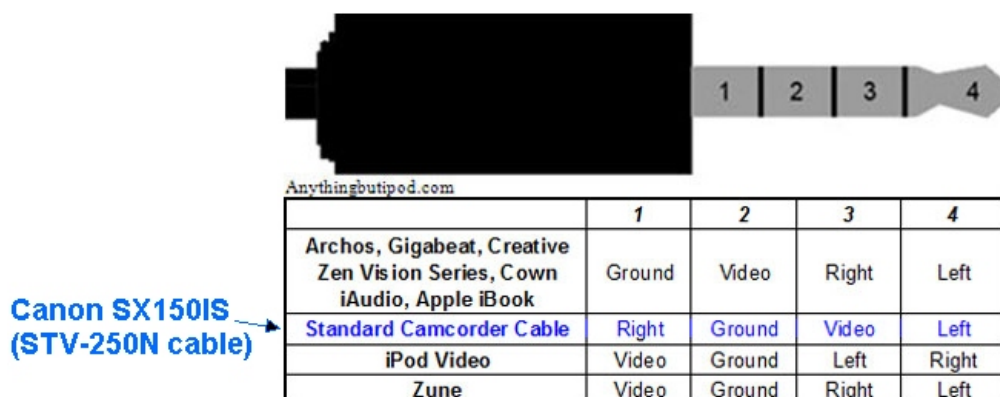
Рис. 2. Классический способ подключения к внешнему телемонитору переходника STV-250N
